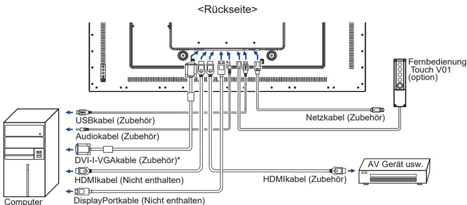
\* Das DVI-D-Kabel ist nicht im Lieferumfang enthalten. Wenn ein qualitativ niedriges DVI-D-Kabel verwendet wird, kann dies elektromagnetische Störungen verursachen. Bitte kontaktieren Sie das iiyama Support Center in Ihrem Land, wenn Sie den Monitor über den DVI-D-Eingang anschließen wollen.
