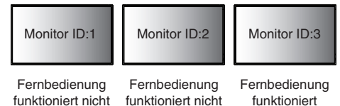
Abbildung 2 Auf der Fernbedienung ist die FERNBEDIENUNGS-ID: 3 eingestellt.
